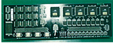
鉛フリーのSMD手実装作業
