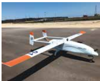
開発用固定翼無人機（翼長4m）
