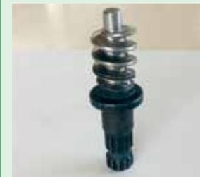
鍛造品二次加工になります。画像は先端加工の後に偏芯させ、一か所ピンポイントに切削加工しています。
