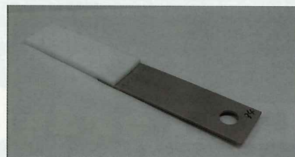
フッ素樹脂（PTFE）とマグネシウム（Mg）の接合加工サンプル▶
