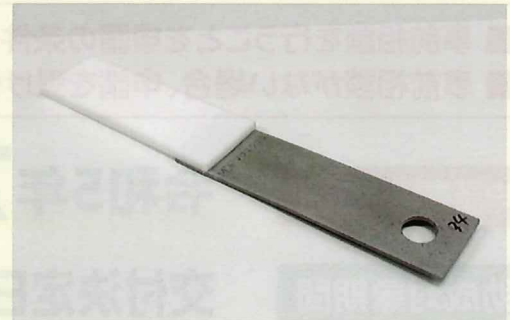
フッ素樹脂 (PTFE) とマグネシウム (Mg) の接合加工サンプル
