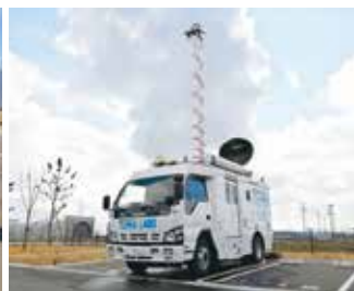
車両移動型地上管制局
