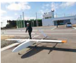
長距離固定翼試作機（翼長4m）
