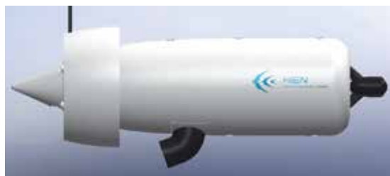
ガスタービンハイブリッドユニット 1/1 スケールモデル
