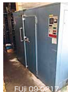
熱風循環式乾燥装置
