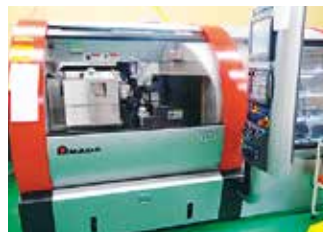
グラフィカルプロファイル研削盤
